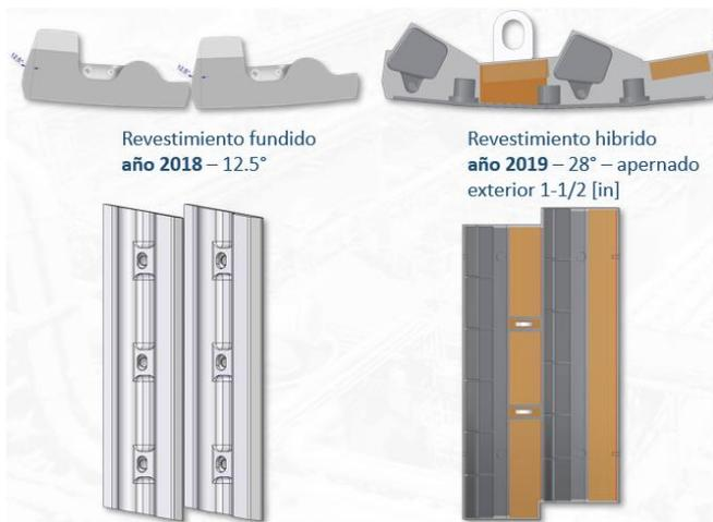
Figura 16. Diseño del revestimiento para el piloto
