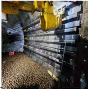
Figura 6. Discharge Shell BM
